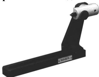
Приспособление предназначено для линейной правки шлифовального круга алмазным карандашом или алмазозаменителем и выверки упорки или оси шлифовальной головки по высоте центров бабок.
