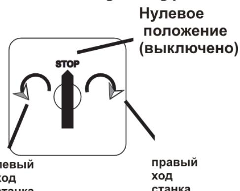
Включение станка производится выключателем, размещенным на правой стороне станка в соответствии с пиктограммой.
