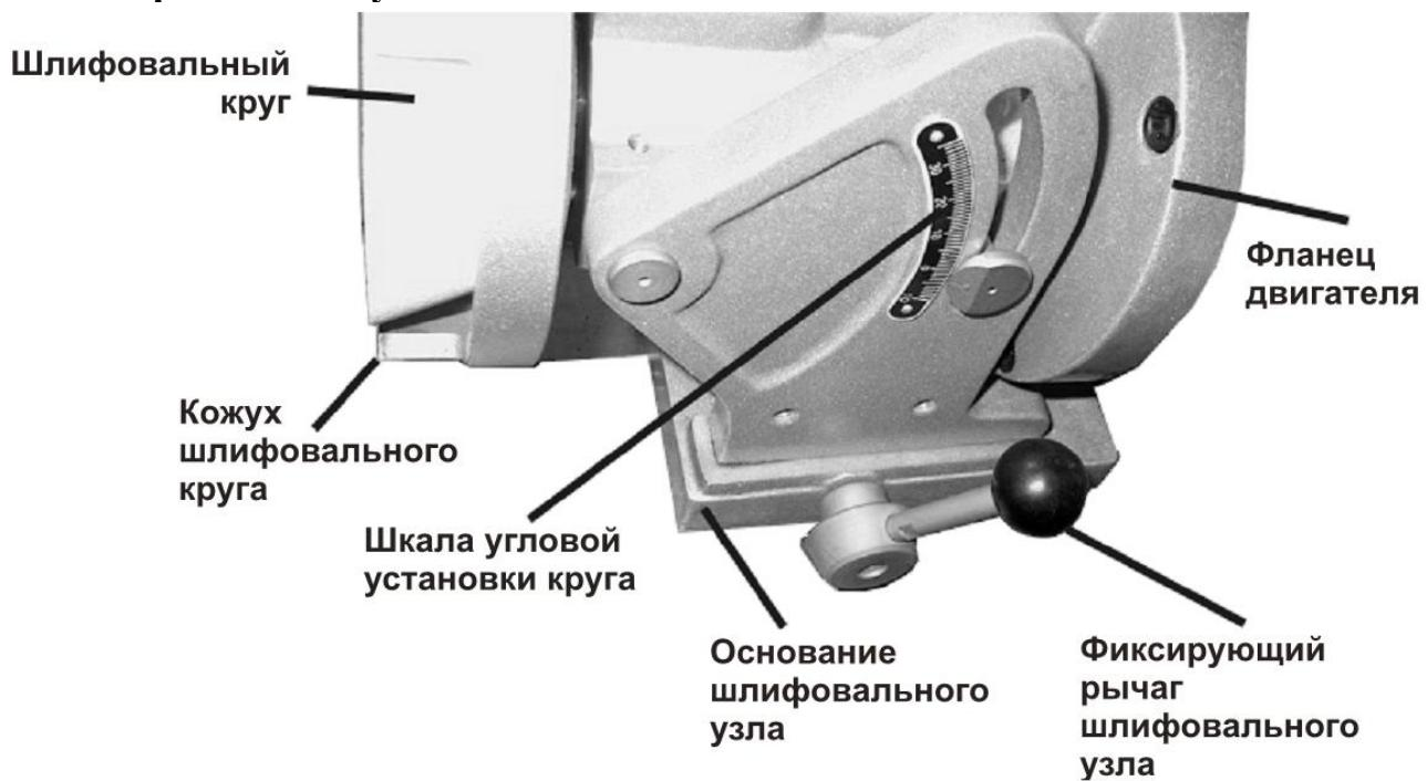
Шлифовальный узел можно произвольно перемещать после расфиксирования рычага. Тонкая подача достигается, как и в случае цангового зажима через маховики, на которых одно деление нониуса соответствует 0,02 мм. Количество делений 100.
