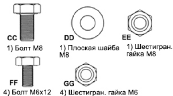
Рисунок 2: Конус и крепежные элементы
