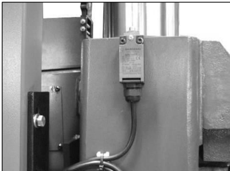
Верхний концевой выключатель высоты пилы.
