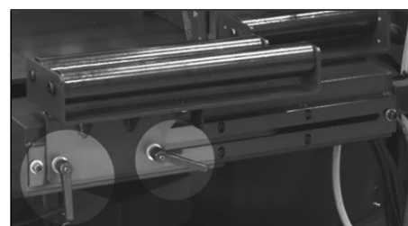
Положение ролика при левосторонней резке.
