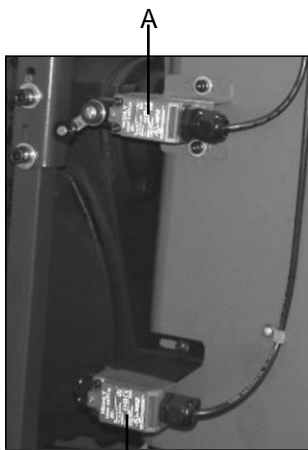
Верхний концевой выключатель высоты пилы.
