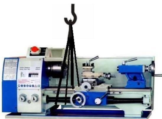
ходового винта). При транспортировании к месту установки и при опускании на фундамент необходимо следить за тем, чтобы станок не подвергался сильным толчкам и сотрясениям. ( см. рис.).
