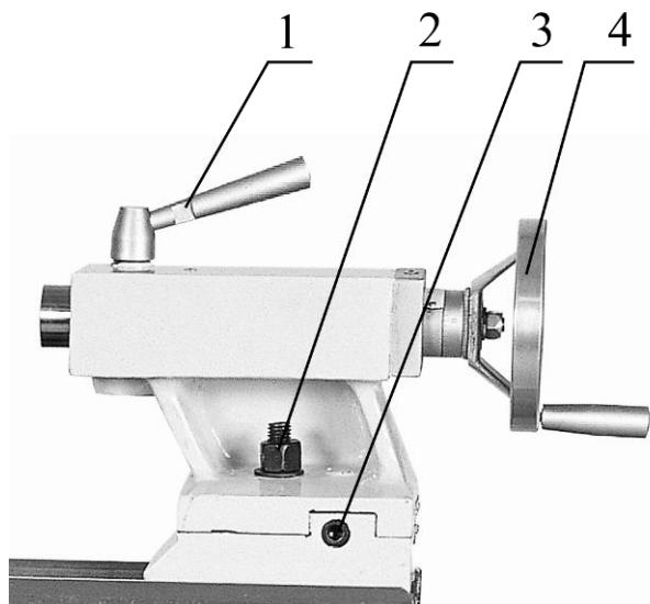
**3. Гайка зажима задней бабки 3:** Вращение против часовой стрелки – открепление задней бабки. Вращение по часовой стрелке – закрепление задней бабки.
