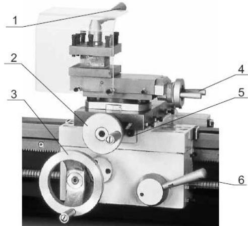
**3. Маховик ручного перемещения каретки суппорта 3:** Вращение против часовой стрелки – перемещение каретки суппорта влево. Вращение по часовой стрелке – перемещение каретки суппорта вправо.
