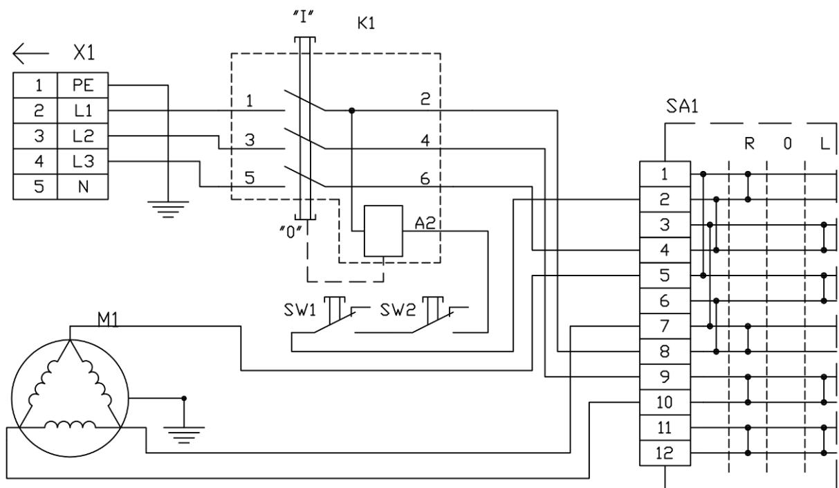
SW1 - Концевой выключатель защитного стекла
