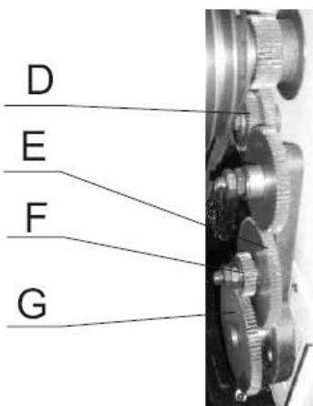
Для замены шестерен D, E, F, G открутите гайки перед шестернями (служащих для фиксации шестерен по оси валов). Снимите шестерни. Установите необходимые шестерни и зафиксируйте их на валах при помощи гаек. Для изменения межосевого расстояния между шестерен ослабьте зажимной болт, измените положение сектора или переместите ось, на которой устанавливаются шестерни Е и F. При
