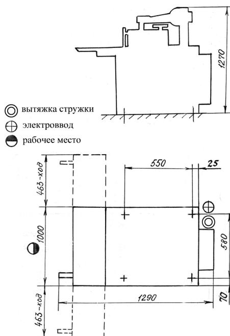
Рисунок 11 Схема установки станка
