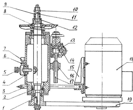
Рисунок 4 Привод главного движения.
