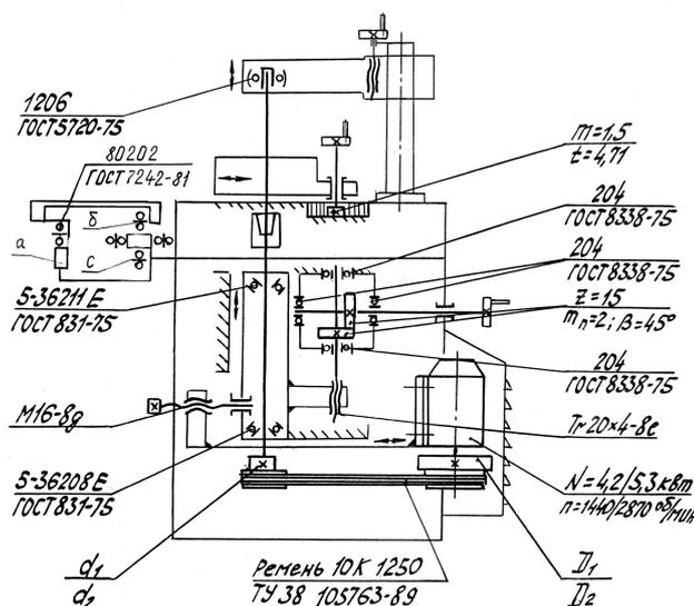
Рисунок 3 Схема совмещенная кинематическая и расположения подшипников.
