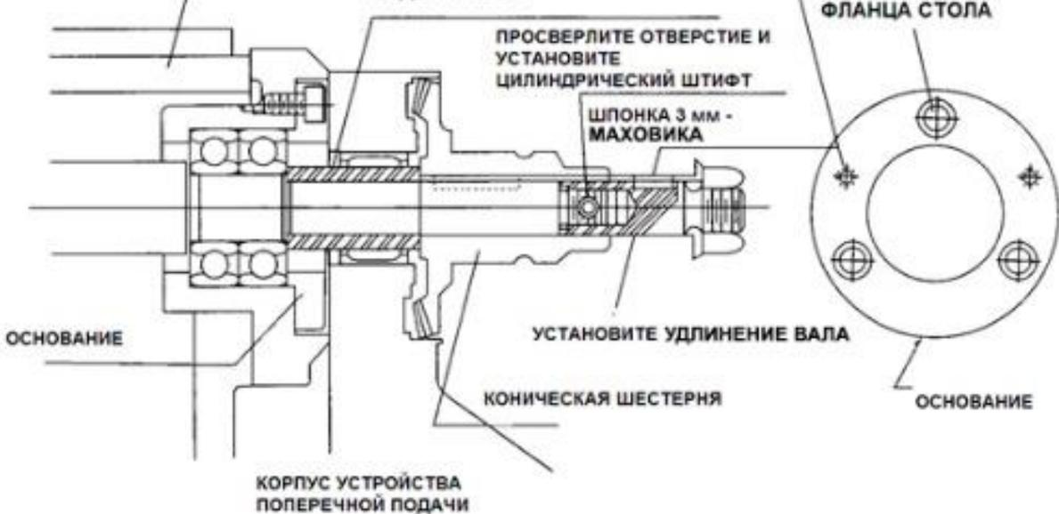
**УСТАНОВКА Т-ОБРАЗНОЙ НАПРАВЛЯЮЩЕЙ ДЛЯ ВЕРТИКАЛЬНОЙ ПОДАЧИ**
