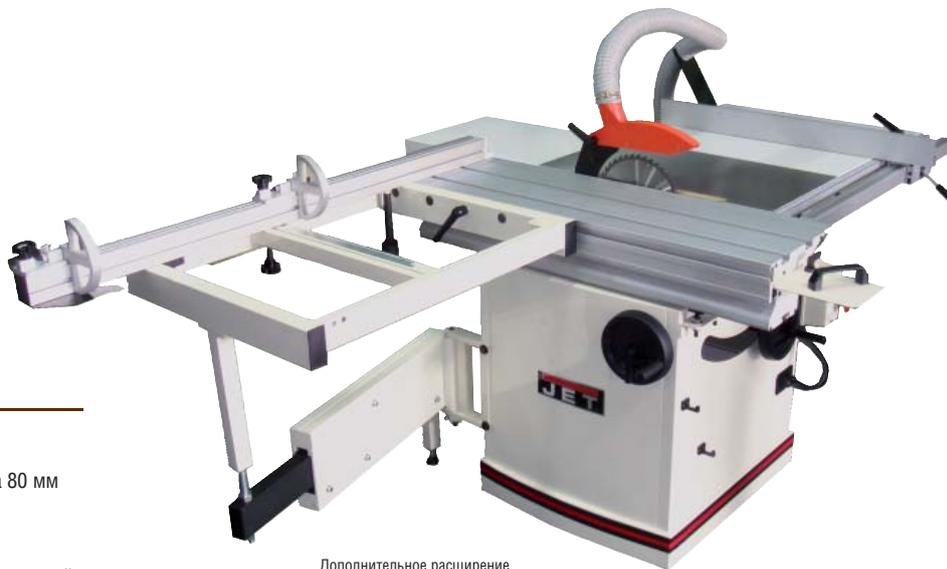
Дополнительное расширение каретки с телескопической опорой не входит в стандартную комплектацию
