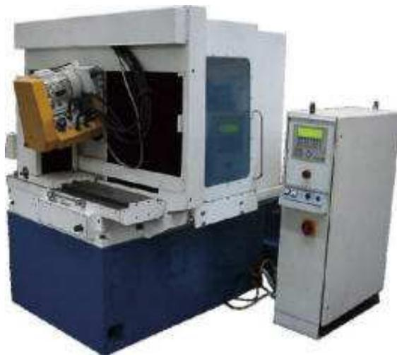
Полуавтомат предназначен для заточки торцовых фрез диаметром 80...630 мм с режущей частью из твердого сплава, минералокерамики, инструментальной или быстрорежущей стали. Заточка производится торцом абразивного, алмазного или эльборового круга с охлаждением или без охлаждения. Заточка, выполняемая с охлаждением торцом алмазного круга, сочетается с электроэрозионной правкой. На полуавтомате пооперационно затачивают все прямолинейные режущие кромки- главные, вспомогательные и переходные.
